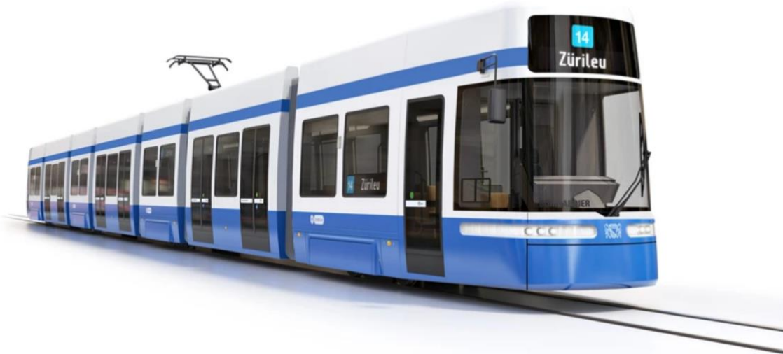
Flexity-2, Bombardier Transportation (heute Alstom), L 42,86 m, 91 Sitzplätze, 188 Stehplätze
